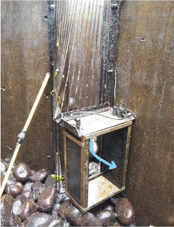
Kuva 5. Ylävirtaan uivat kalat ohjataan ohjainkehikon avulla uimaan VAKI-laskurin skannauslevyjien välistä.
